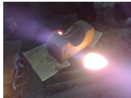
Fig 3.1(d): Metal Poured
